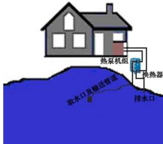
图 8-4 开式间接式湖水源热泵系统
